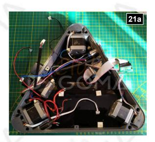
Adaptation du connecteur de témoin du bouton poussoir : Les contacts de ce témoin étant plus éloignés sur la carte F5 que sur la MKS, il faut le modifier. Si l'on dispose de connecteurs unipolaires Dupont, il faudra éliminer celui en place pour équiper chacun des 2 fils d'un unipolaire, sinon :
